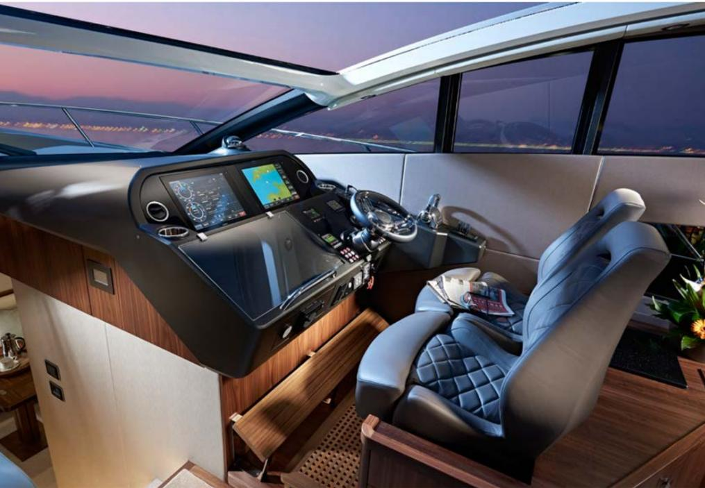
ручки управления двигателями и подруливающими устройствами, а остальное доступно на двух больших сенсорных экранах.
