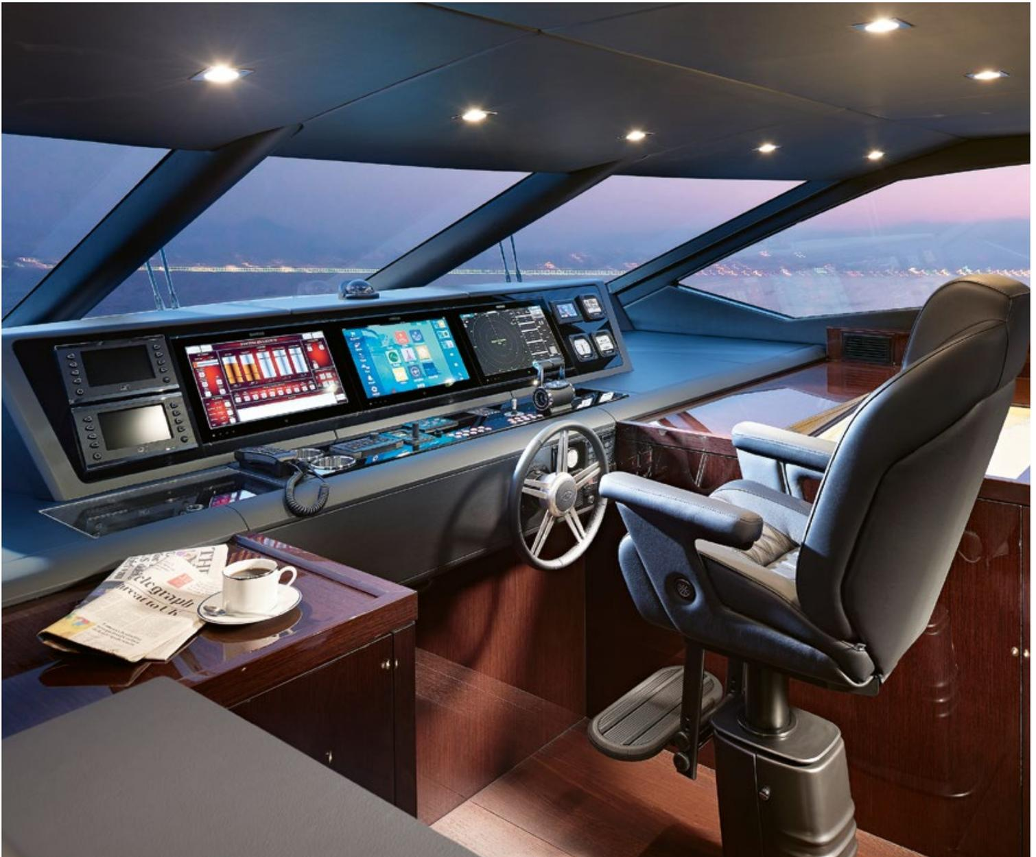
95-ая, которую прозвали «карманной суперяхтой», относится к типу Raised Pilot House (яхт с приподнятыми рулевыми рубками) с типичным для таких яхт постом управления, расположенным между главной и верхней палубами. Помимо очевидных преимуществ для капитана в плане обзора, благодаря такому решению, мастер-каюту удалось разместить в носовой части главной палубы, а нижняя палуба полностью отдана под гостевые апартаменты.
